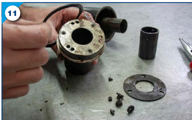
5. Nettoyez les différentes pièces au dégraissant.
