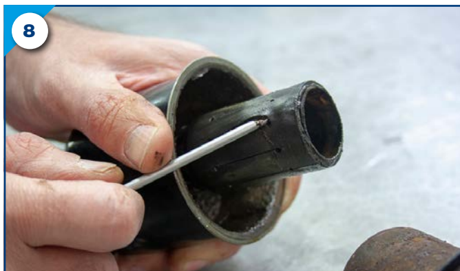
4. Enlever les anciens joints à l'aide d'un tournevis plat dans l'ordre indiqué dans les photos 8 à 11.
