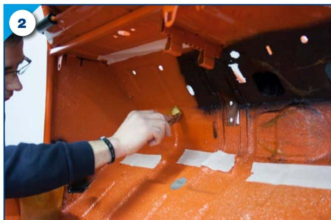
2. Laissez évaporer les solvants, lorsque la surface n'est plus adhérente au toucher, assemblez les deux parties (photo 3).
