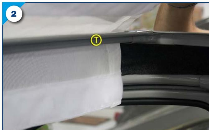
**3.** Fixez le tendelet sur le long de la traverse centrale «T» via le système de velcro.
