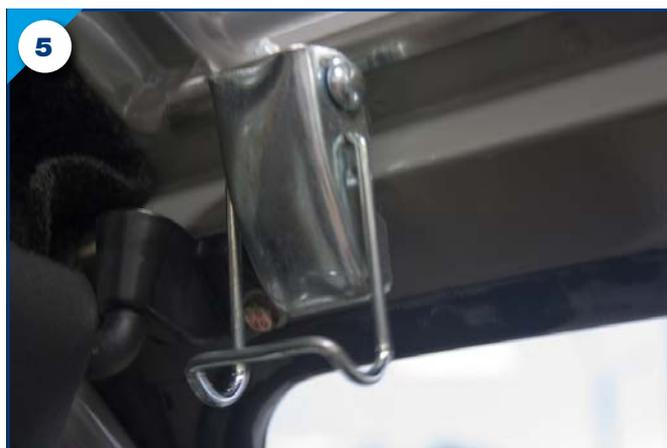
**5.** Positionnez le tendelet sur l'avant de la caisse de la 2CV et passez-le autour du «U» d'ouverture.
