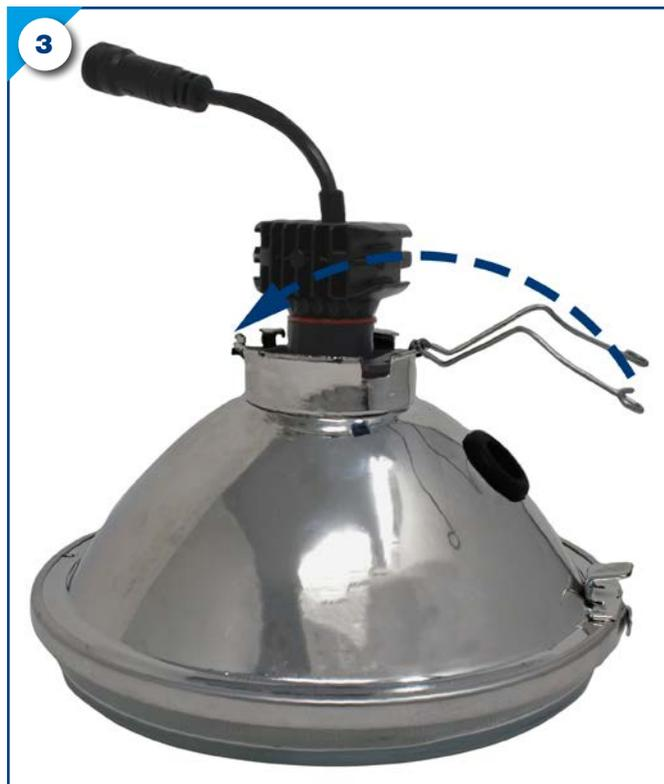
2. Positionnez l'ampoule LED sur l'optique.
