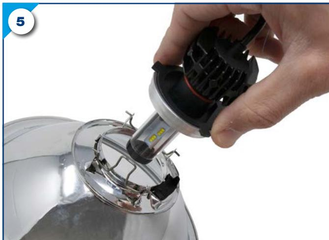
**4.** Verrouillez l'ampoule LED à l'aide du circlips de retenu.
