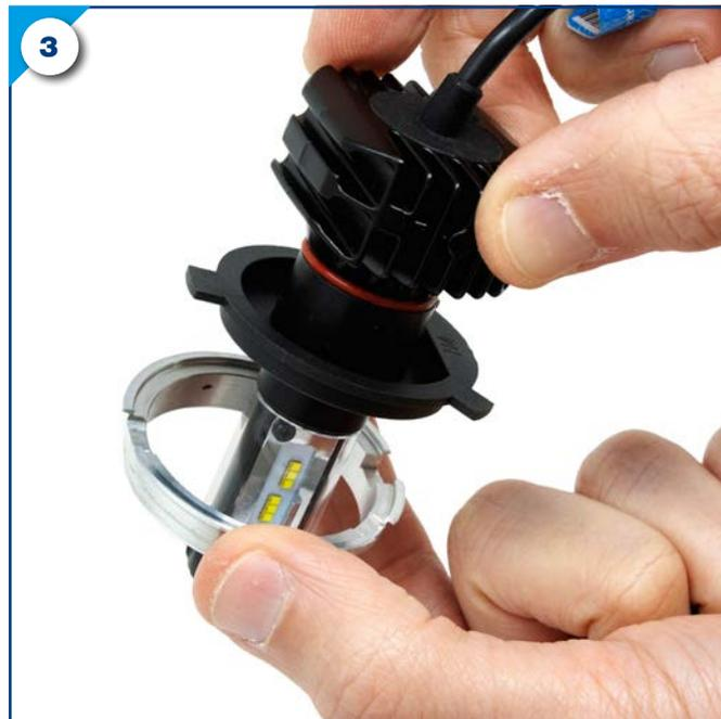
**2.** Placez la bague de montage H4 sur CE (réf. 1830141) sur l'ampoule LED.
