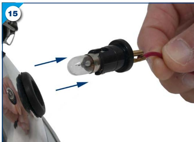
**9.** Remplacez-la sur le support d'origine par l'ampoule de veilleuse LED (réf. 1830040).
