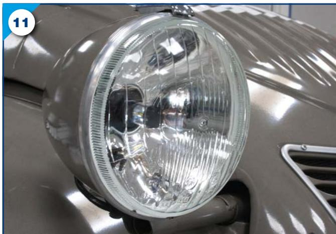
**Pose de l'optique sur un cuvelage de phare de Méhari ou Dyane**
