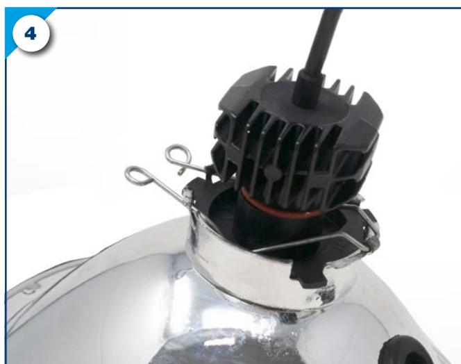
**4.** Branchez le ballast grâce à la prise ronde en veillant à ce que le détrompeur C soit aligné avec la fente D.
