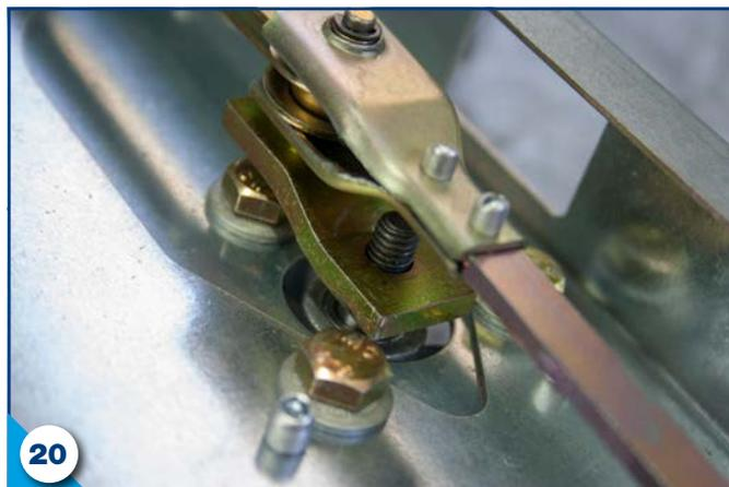
**11.** Introduire les biellettes dans le support moteur et les fixer au moyen des rondelles **H** et **I** et des écrous livrés avec les biellettes. Il faut veiller à positionner la rondelle **H** (la plus fine) en dessous du support de moteur et la rondelle **I** au-dessus de ce dernier, l'écrou venant se visser par dessus, à l'aide de la clé plate de 22 mm. Voir photo 18.
