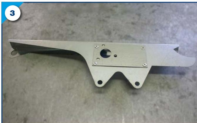
3. Repérer les 2 zones à percer pour la fixation du moteur (photo 4), puis percer les 2 trous en utilisant un foret de 6 mm pour métal.
